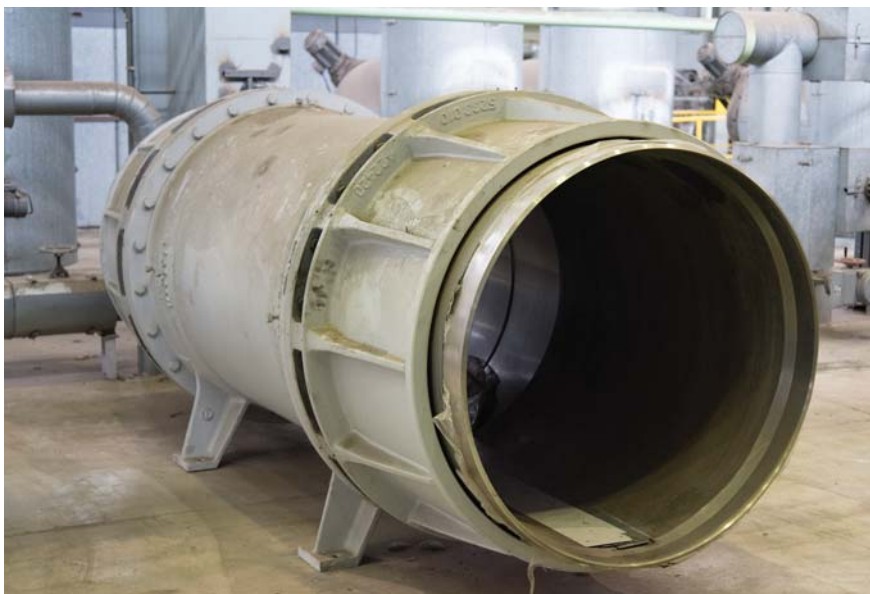
Dvojitý kompenzátor (DN 1200 horkovodu) pro zásobování teplem města Prahy. Kompenzátor je připravený na výměnu v letní, sedmidenní, odstávce.
