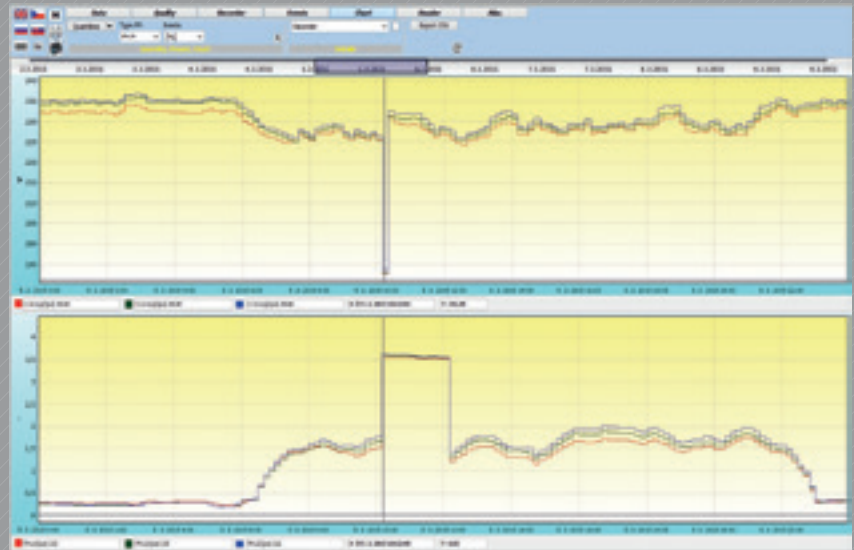
Rys. 2 - Przebieg czasu średnich dziesięciminutowych napięć fazowych i współczynnika migotania światła Plt w dniu 5. 3. 2015r.
