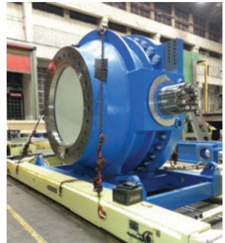
Kulový uzávěr DN: 2400 pro vodní elektrárnu Innertkirchen ve Švýcarsku (výrobce Litostrój Power)
