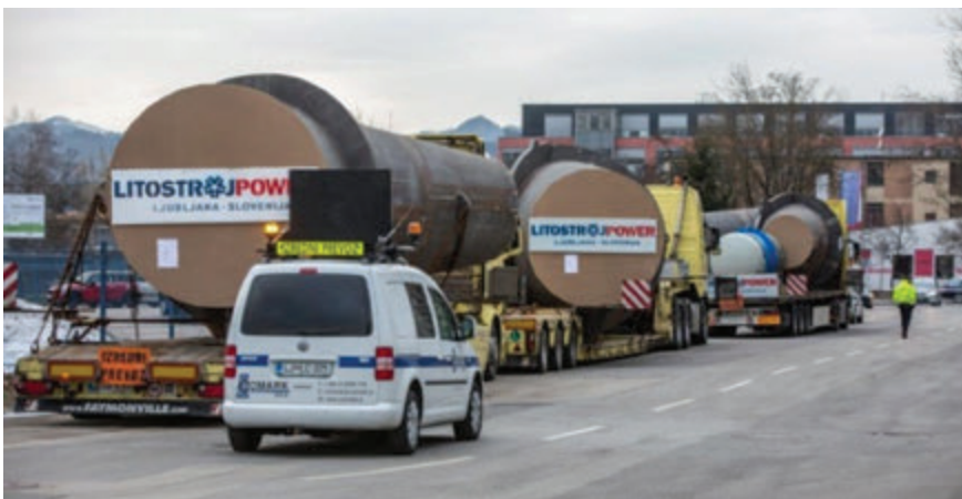
Transport sběrného potrubí pro vodní elektrárnu Big Silver Creek v Kanadě z Litostrój Power (Slovinsko)
