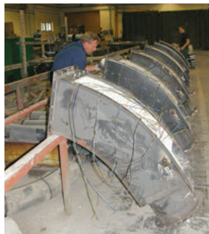
Kompletace čtvercový oblouk u výrobce včetně systému měření životnosti
