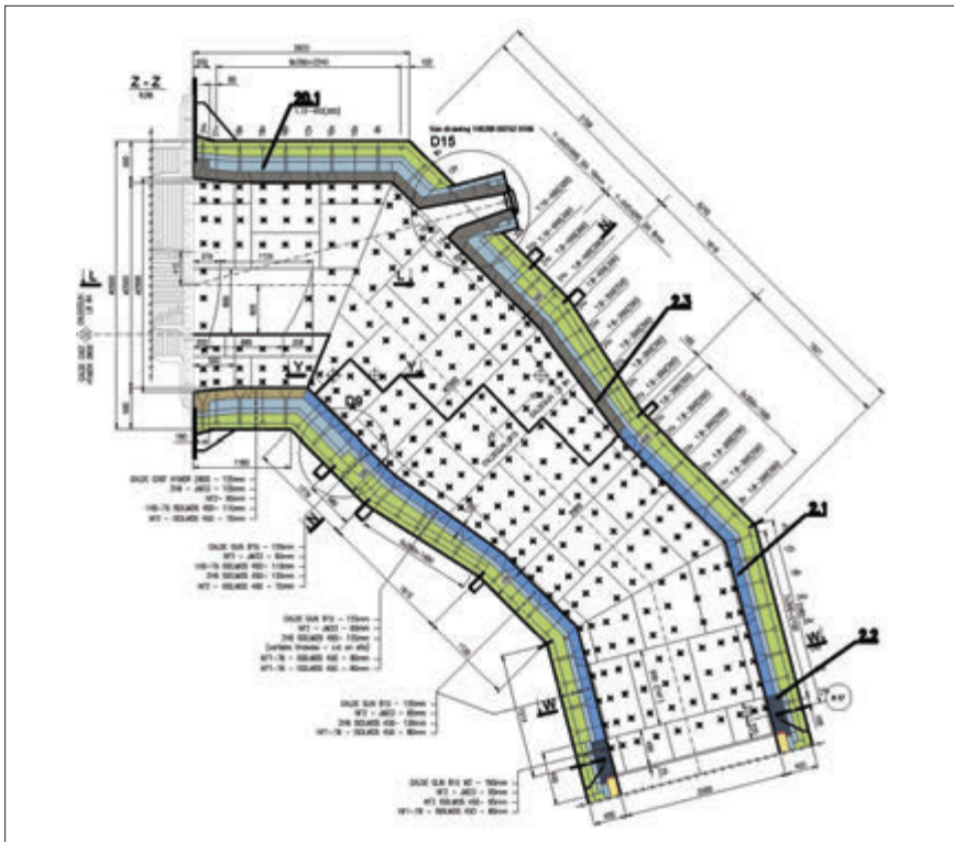
Hlava sušící šachty
