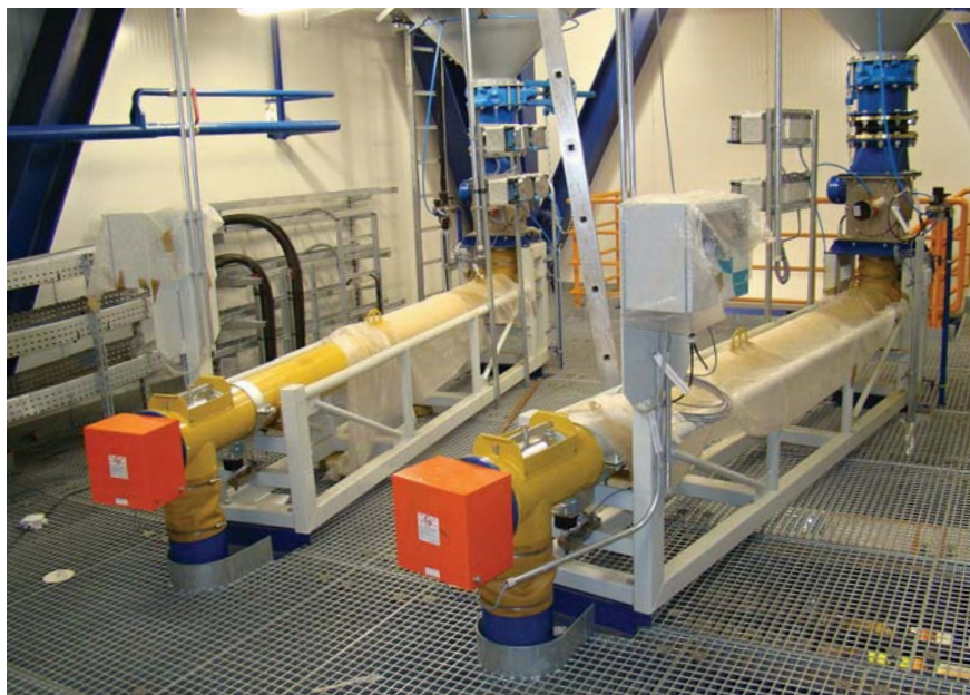
Válcový šnekový dopravník mletého vápence
