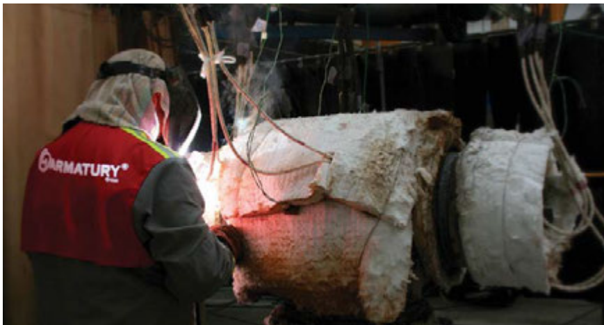
Obr. 4 – Svařování heterogenního spoje v ARMATURY Group Dolní Benešov
