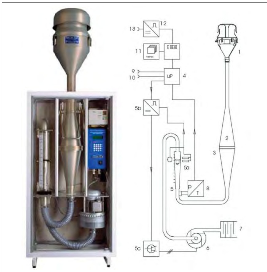
Obr. 4 – Příklad zařízení pro vzorkování prachových a aerosolových částic DH 77 – Digital
