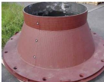
Obr. 3 – Díly kaskády třídíče v cementářském průmyslu. Na tomto obrázku má účinný materiál Vickersovu tvrdost mezi 450 a 580 HV [1]
