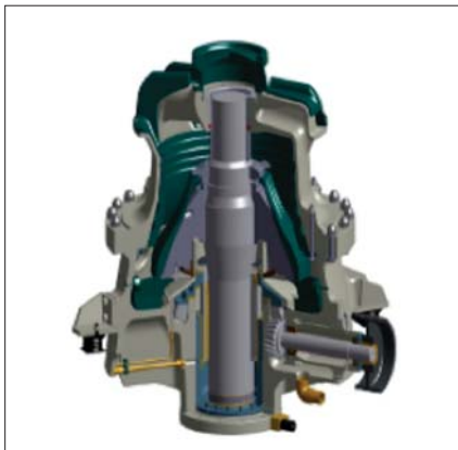
Obr. 9 – Řez konstrukcí kuželového drtiče
