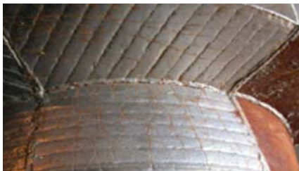
Obr. 24 – Deska vystavená opotřebení po více než 1 000 hodinách nasazení
