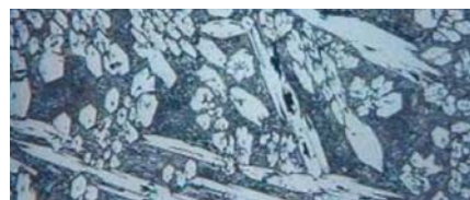
Obr. 5 – Snímky klasického materiálu proti čistému abrazivnímu otěru pořízené světelným mikroskopem, slitina FeCrC
