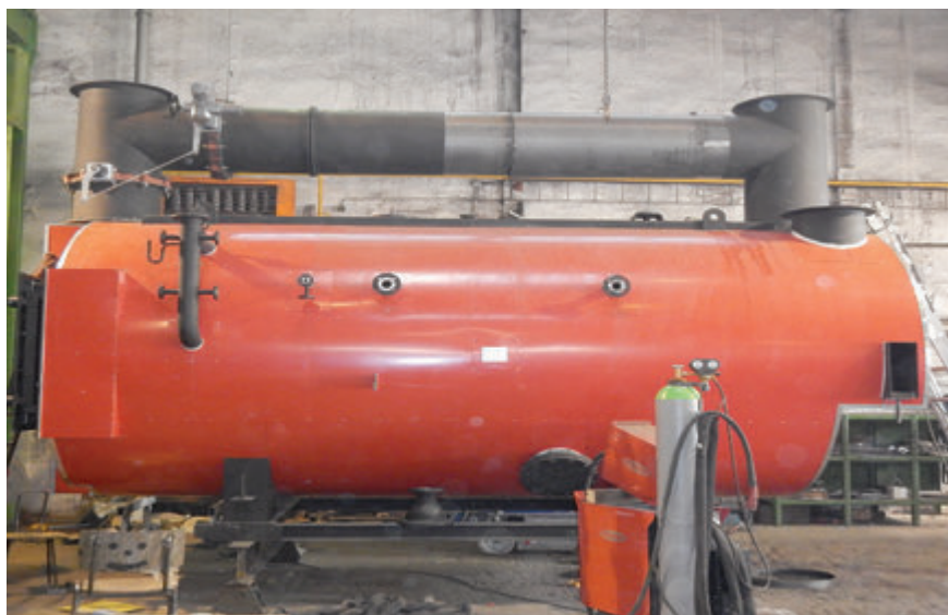
Snímek z výroby kotle THS 25/7 - KOMBI
