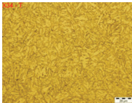
Obr. 7 – Mikroštruktúra v stave 780°C/6 hod
