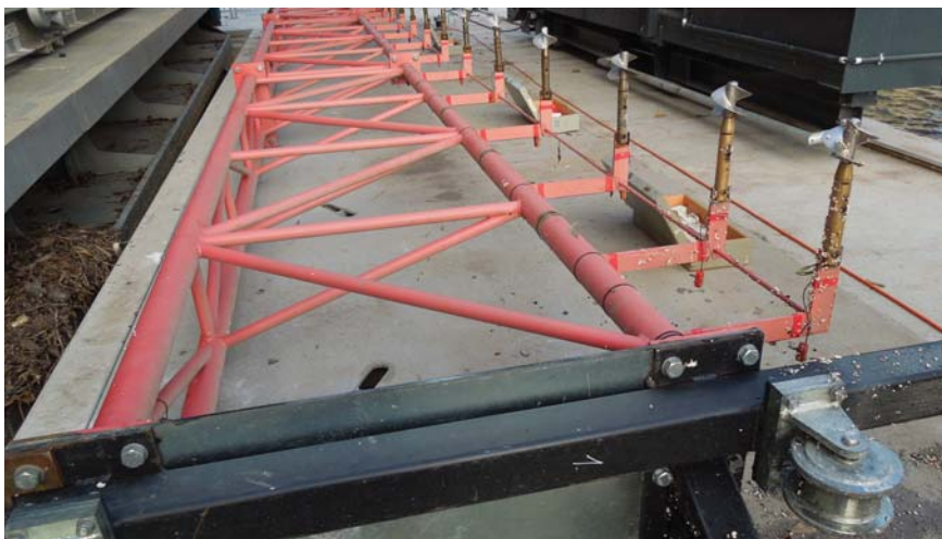
Rám s hydrometrickými vrtulemi po vytažení z měrného profilu
