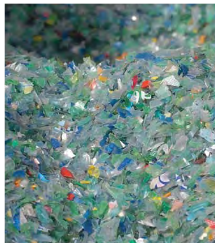
Z PET lahví se v SITA CZ vyrábí plastová drť - a z ní následně vlákno pro výrobu textilií
