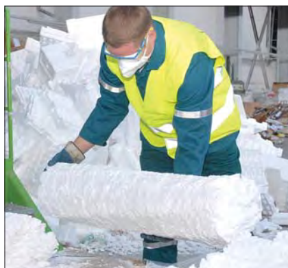
Prioritou SITA CZ je další materiálové využití odpadů. Například vytríděný polystyren je pomocí styropáktoru zhužněn a předán výrobci izolačních materiálů.
