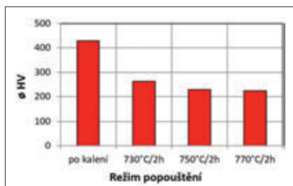
Obr. 4 – Průměrná tvrdost HV30 v závislosti na režimu tepelného zpracování
