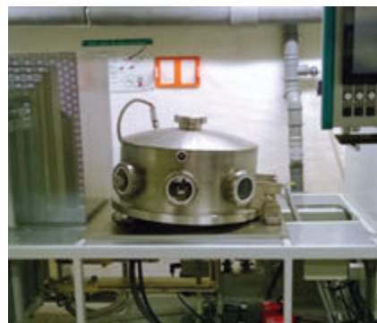
Obr. 7 – Celkové uspořádání teplotního simulátoru, zkušební vzorek je umístěn ve vakuovacím zvonu
