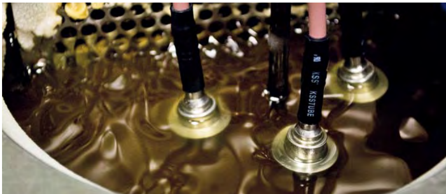
Obr. 8 – Kalibrace kabelových snímačů teploty při teplotách nižších než 0 °C v olejové lázni
