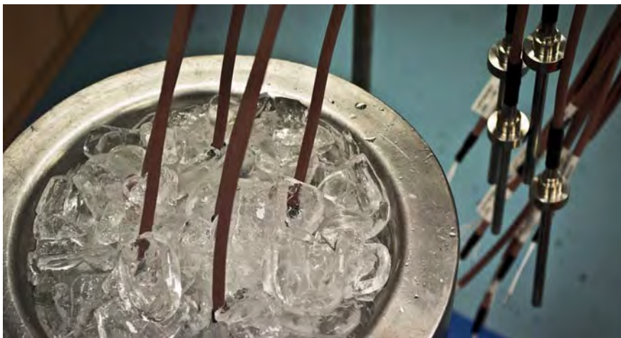
Obr. 7 – Kabelové snímače teploty v ledové lázni při kalibraci 0 °C v Dewarově nádobě
