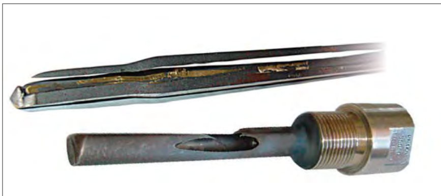
Obr. 5 – Jímky bez ochranného povlaku poškozené abrazi
