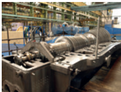
❏ Kombinowana część WP / SP przy montażu kontrolnym
