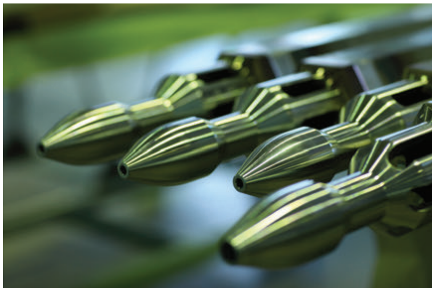
Hlavice palivových kazet pro reaktor BN-800, které obsahují palivo MOX
