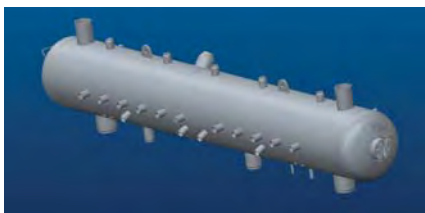
3D model - kotlové těleso
