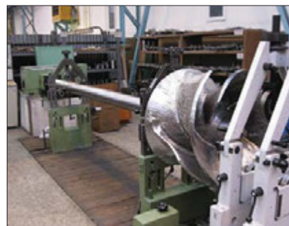
Vyvažování rotoru čerpadla 900-BQBV
