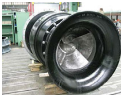
Čerpadlo 900-BQBV před dokončením
