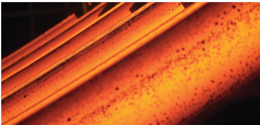
Kontinuální odlévání oceli v Třinci
