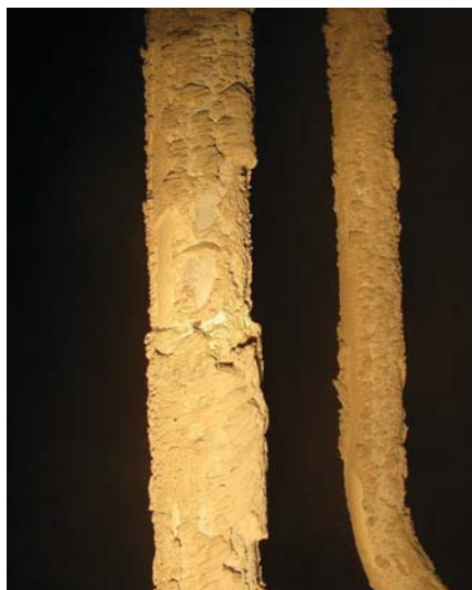
Obr. 4 – Porovnání zanesení trubek výparníku před a po odstávce a údržbě (říjen 2014)
