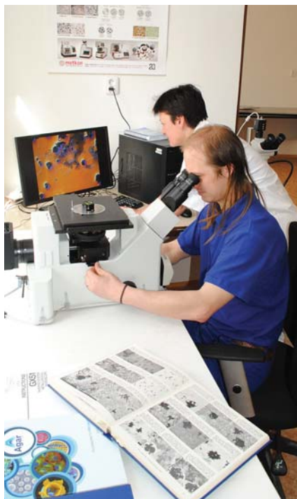
Metalografické hodnocení mikrostruktury kontejneru na jaderný odpad
