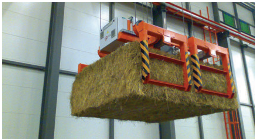
Speciální uchopovací kleště na přepravu dvou kusů balíků
