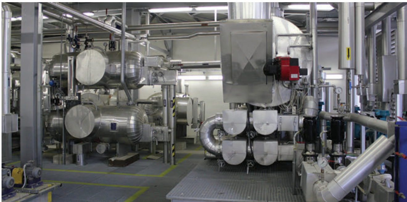
Technologie sušení plynu - regenerátor TEG
