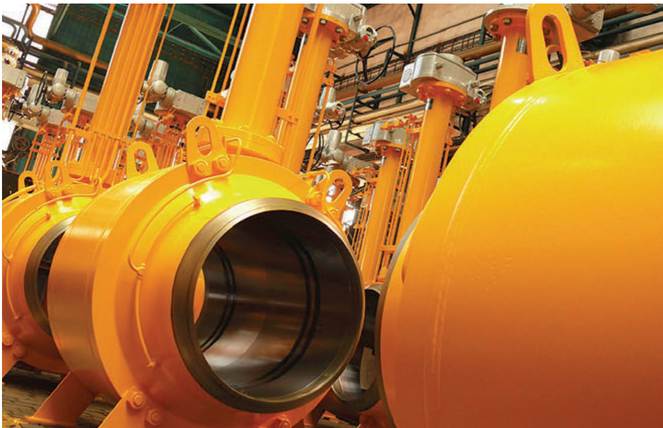
Guľové ventily v podzemnom vyhotovení, s vyššou svetlosťou, expedované do Indie na stavbu ropovodu
