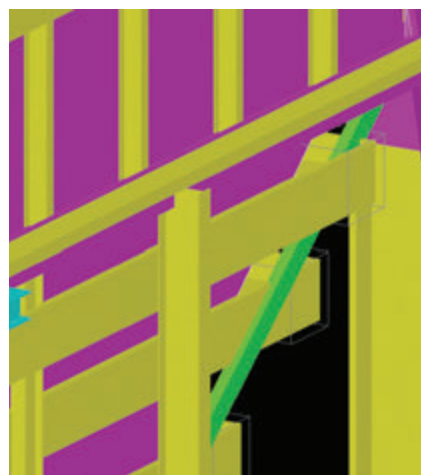
Obr. 5 – Zaholdované detaily v realizačnom projekte
