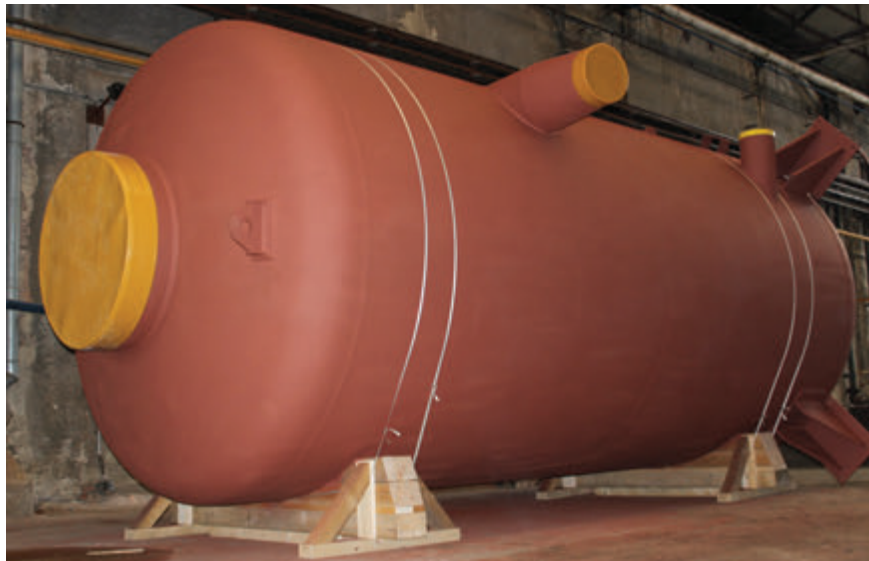
Expander EPKII pro zakázku "Komplexní obnova Elektrárny Pruněřov II" před expedicí
