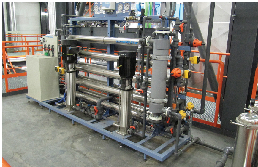
Dvoustupňová reverzní osmóza typu DPRO B2-10/6 s integrovanou čisticí jednotkou a membránovým odplyňovačem \text{CO}_2
