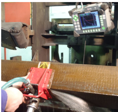
Obr. 4 Zkoušení sochoru imerzní hlavicí v dynamickém režimu s indikací vady
