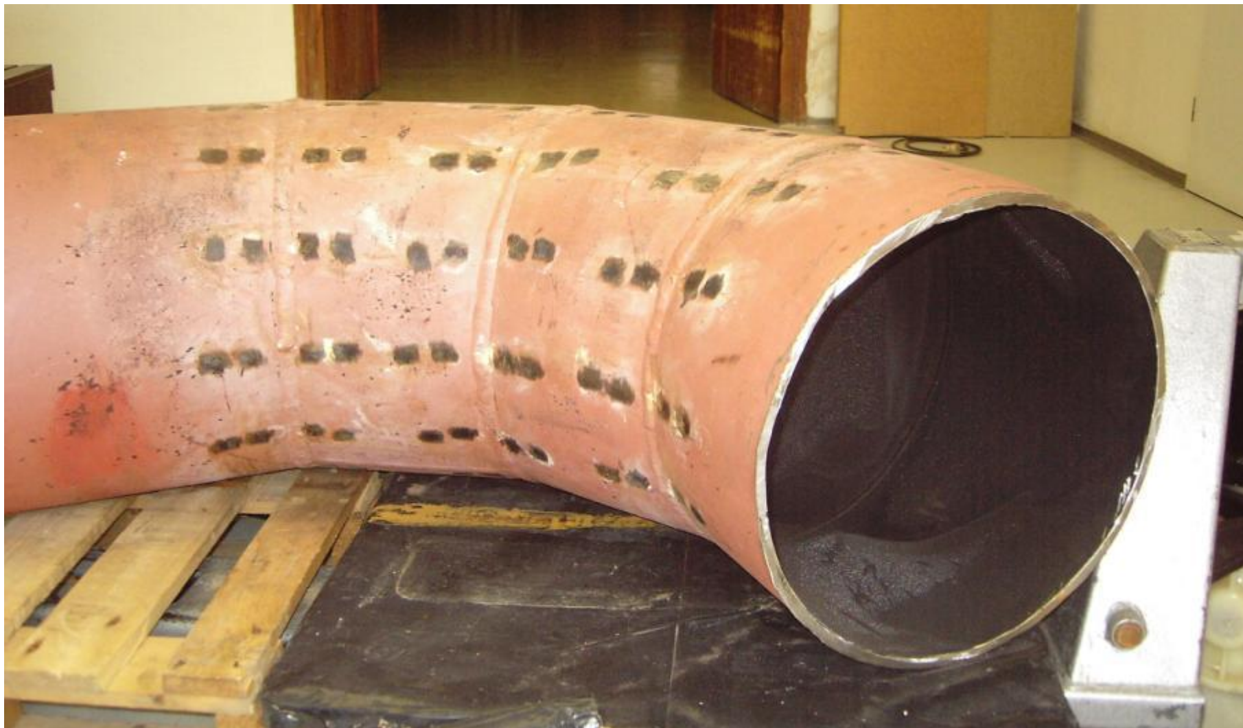
Poškozené koleno parovodu
