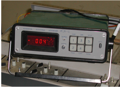
Obr. 7 Zařízení ION-C pro měření ZN a jeho sonda při kalibraci vzorku
