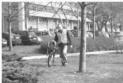
Praktické provádění inspekce potrubí uloženého v zemi
