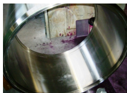
Obr. 18 Generátorová obruč Fig. 18 Generator ring
