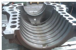
Obr. 4 Turbinová skříň Fig. 4 Stator casing
