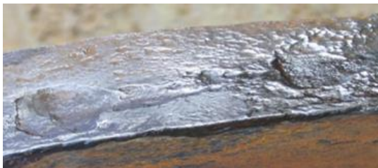
Obr. 5 Příprava povrchu k kapilární zkoušce Fig. 5 Preparation of the surface for capillary test
