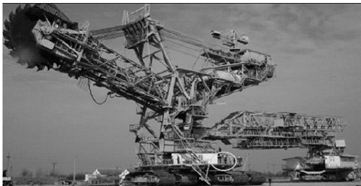
Obr. 1. Hornické rypadlo - základní stroj v povrchovém hornictví. O velikosti stroje svědčí skupina pracovníků označená kolečkem Fig.1 Mining excavator - basic machine in strip mining.
