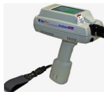
Obr.24 Přenosný ramanovský spektrometr
