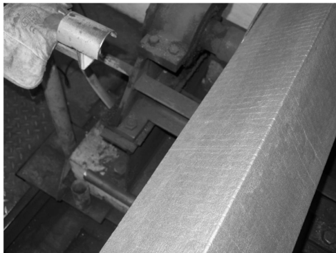
Obr.4 Snímání povrchu sochoru laserovým profiloměrem
