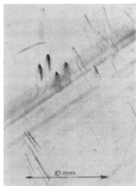
Obr.2 Poruchy v monokrystalech křemene
