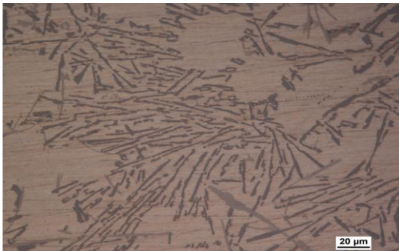
Obr. 2. Vzorek 1W (nemodifikovaný stav) – zv. 500x Fig. 2. Sample 1W (no-modification) – inc. 500x
