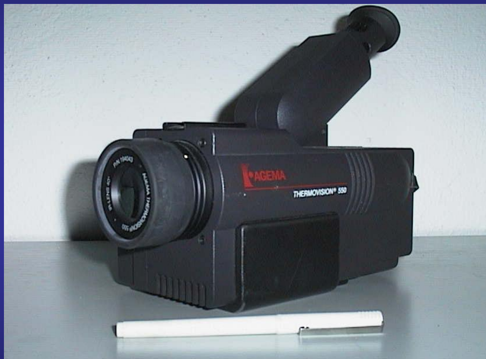
Příklad termografického zařízení - klasické kamery značky Agema
