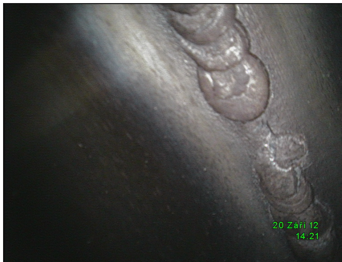
Defekt 2 – Neprovařený kořen v délce 3 mm
