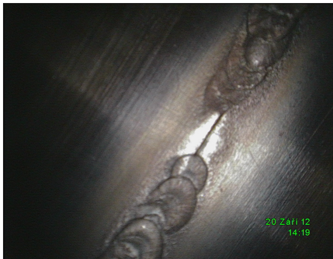
Defekt 2 – Neprovařený kořen v délce 3 mm
