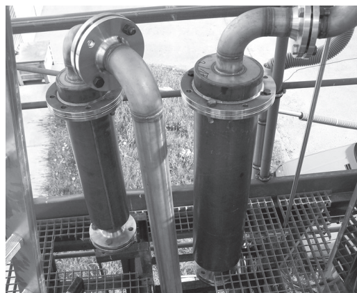
Filtry pro aplikaci kovových katalyzátorů
